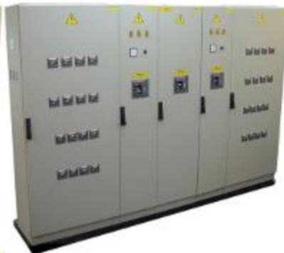
АВР - щит автоматического ввода резерва осуществляет автоматический ввод резервного питания установки при отключении питания на основном вводе, или при отклонении напряжения любой фазы от установленного значения. При восстановлении питания на основном вводе, возможен
