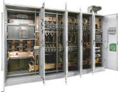
Щит ГРЩ — это главный распределительный щит, который предназначен для приема и распределения электроэнергии в трехфазных сетях с напряжением 380/220 вольт с частотой 50 герц, а также защиты отходящих линий от коротких замыканий и перегрузок. ГРЩ используются при электроснабжении промышленных, коммерческих и общегражданских объектов.
