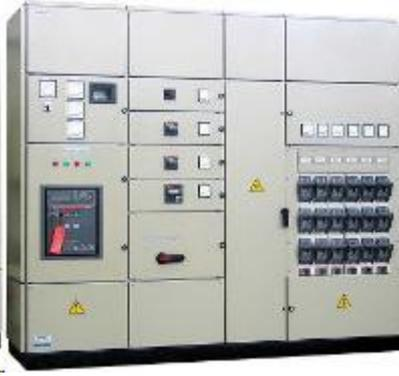
ВРУ - вводное распределительное устройство, предназначено для приема, учета и распределения электрической энергии напряжением 380/220 В переменного тока частотой 50 Гц с глухозаземленной нейтралью в электроустановках жилых и общественных зданий, промышленных помещений, а также для защиты отходящих от ВРУ распределительных и групповых цепей при перегрузках и коротких замыканиях.
